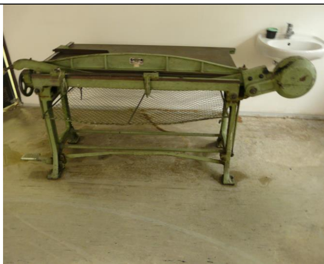
Tabuľové nožnice na lepenku, inv.č. z49266/0001 Výrobok fabriky Kovopodnik Pardubice, typ 50/125
